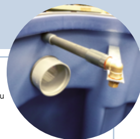
Détail de la buse d'arrosage interne au séparateur
